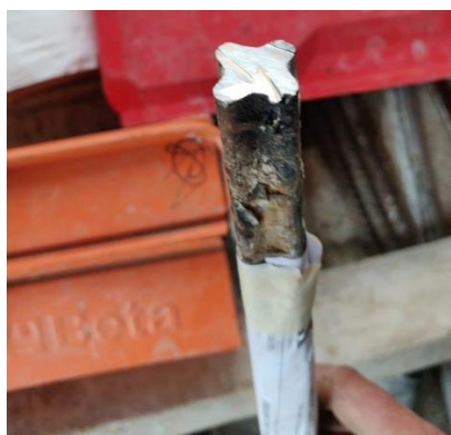
Figura 15 – Barra di armatura trave principale – Acciaio LU 3 RUMI 4400
